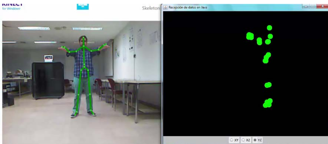
Fig. 9. Representación del esqueleto en el plano YZ.
